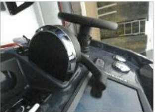
Sur notre bateau, la manette des gaz vient buter contre l'écran du HOS 12 Lowrance.
