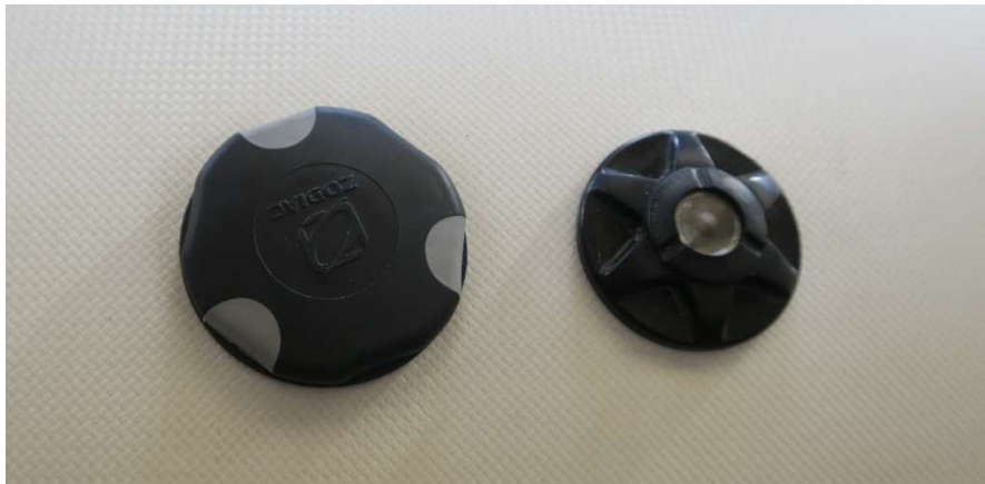
Valve de gonflage (gauche) et de surpression (droite)
